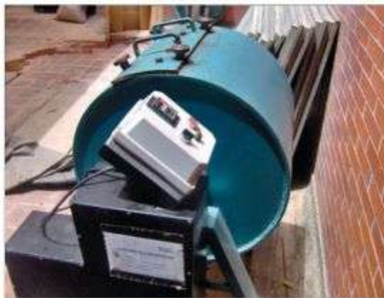
Vista del dispositivo los ángeles para el ensayo Cántabro
