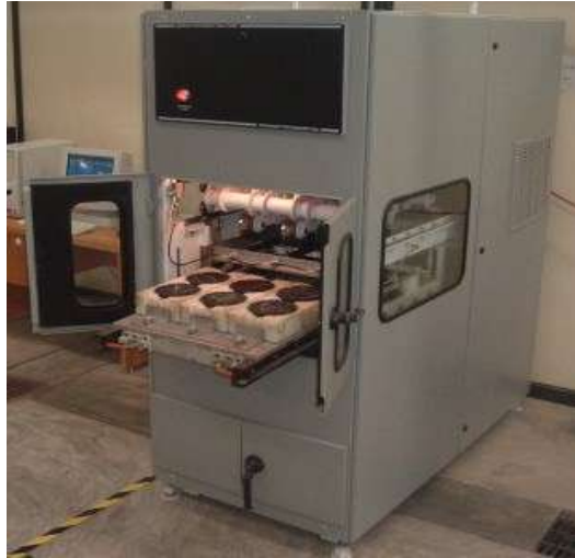
Vista del analizador APA
