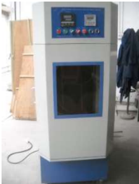
Vista del compactador Roller Compact disponible en el LEMaC
