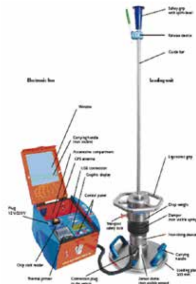
Figura 1. Light Weight Deflectometer (Fuente: TERRATEST)
