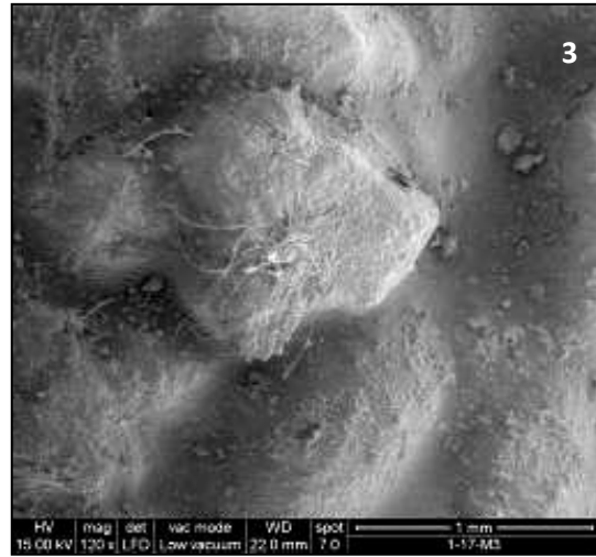
Figura 3: Mortero de cemento con 10% de "filler"
