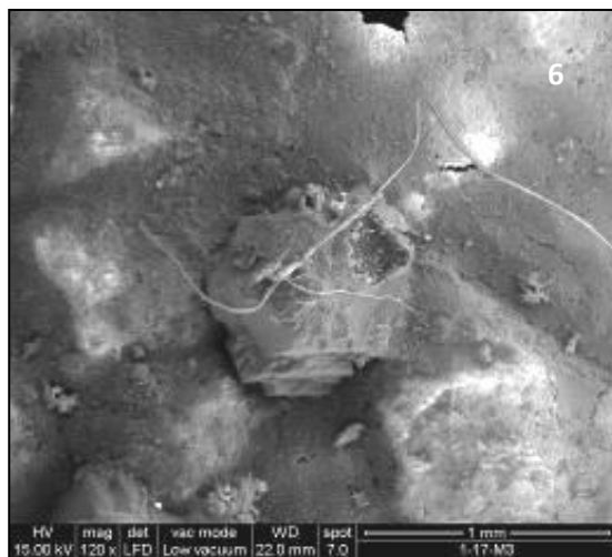
Figura 6: Mortero con 20 % de puzolana.
