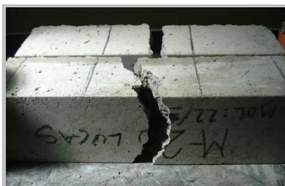
Foto2. Forma de rotura en flexión
