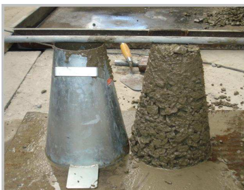
Foto1. Asentamiento hormigón H-90
