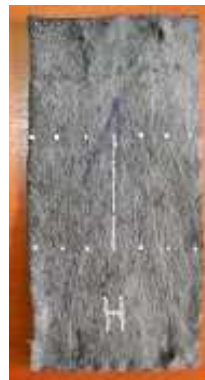
Figura N°1. Probeta con líneas de centrado Fotografía N°1. Probeta con líneas de centrado
