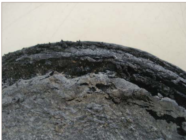
■ Figura 3. Borde dañado de una placa.
