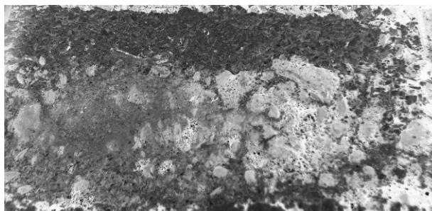
Foto N° 2. Pastilla original con el 30 por ciento de exceso de emulsión llevada a escala de grises
