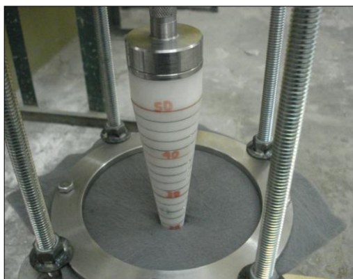
Foto Nº 12: Cono de medida dentro del orificio.
