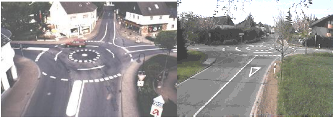
Figura 1 – Demarcación de una mini-rotonda
