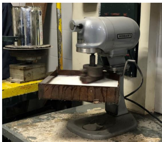
Figura 1. Ensayo de abrasión por vía húmeda en marcas viales
