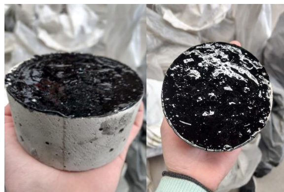
Figura 7. Probetas de hormigón con riego de adherencia.
