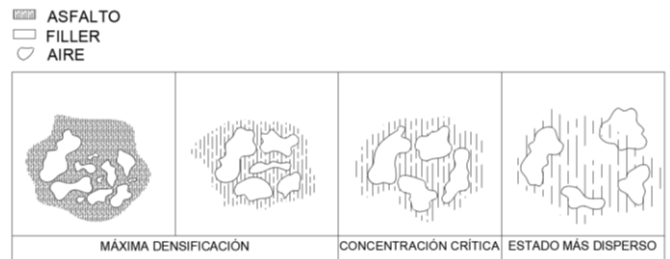
Figura 1. Dispersión asfalto – filler en distintas proporciones. Fuente: elaboración propia.
