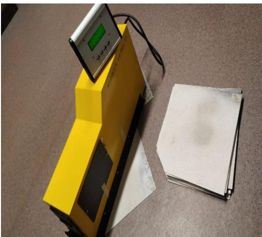
Figura 5. Evaluación de la retroreflexión de las marcas viales. Fuente: elaboración propia.
