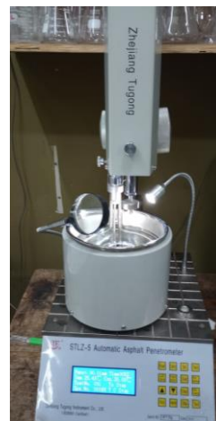
Figura 1 - Equipo Automático de penetración.
