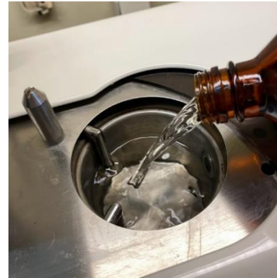
Fig. 9. Introducción de líquido dispersante.
