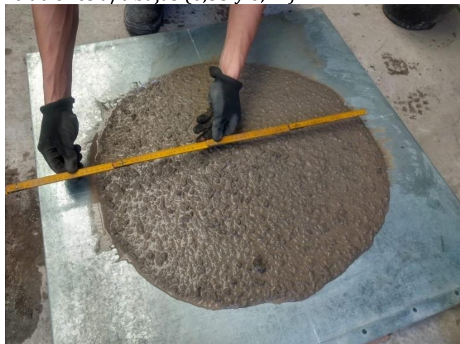
Figura N°1: Segregación producto de la dosificación 2, visualizada al realizar el ensayo Extendido.
