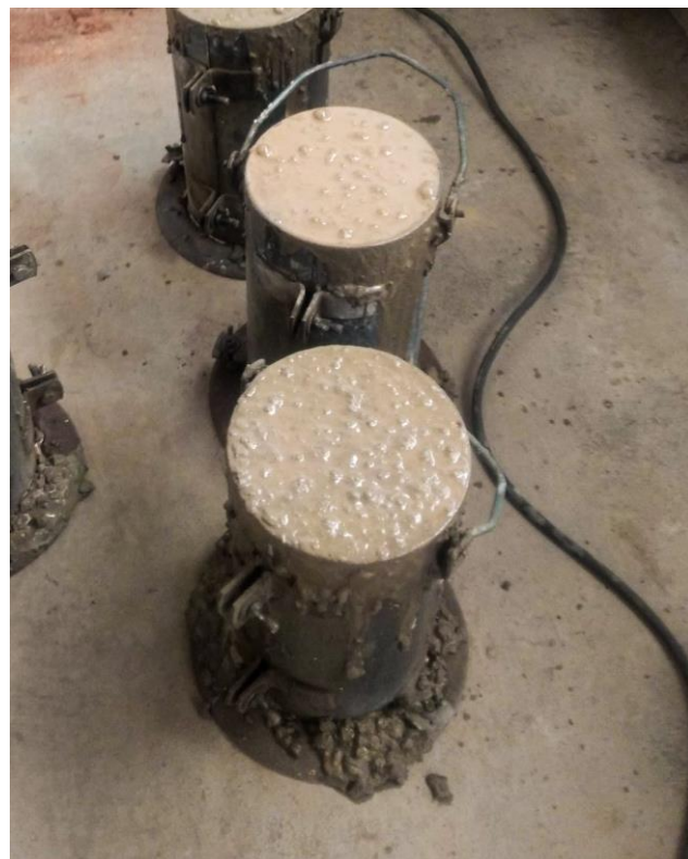
Figura N°2: Segregación producto de la dosificación 2, visualizada al confeccionar las probetas.
