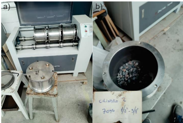
Figura 2. a) Equipo para el ensayo Micro Deval, LEMaC. b) Detalle de tambor con muestra en su interior.
