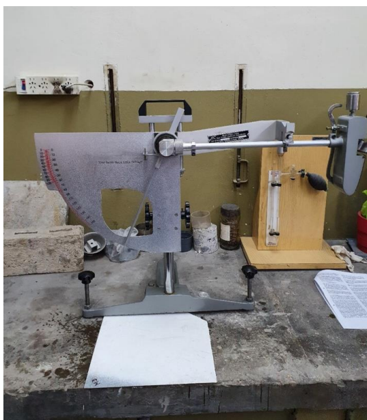
Figura 2. Evaluación de la resistencia al deslizamiento en marcas viales
