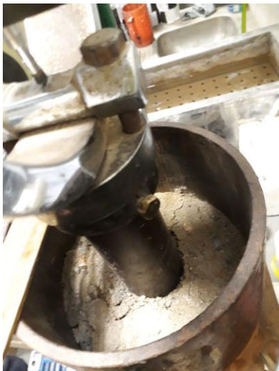
Figura 6. Ejemplo de ensayo de VSR sin pesa
