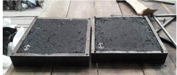
Figura 6. Bases para las probetas moldeadas con Roller Compact.
