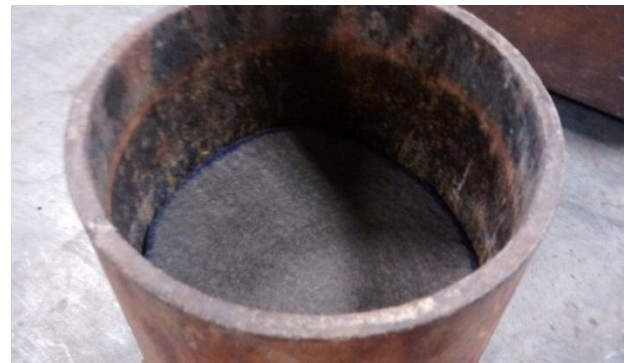
Figura 14. Colocación de geosintéticos no tejido
