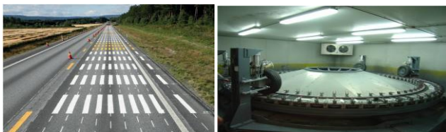
Figura 1. Izq.: Campo de ensayo; Der.: Simulador de desgaste AETEC España
