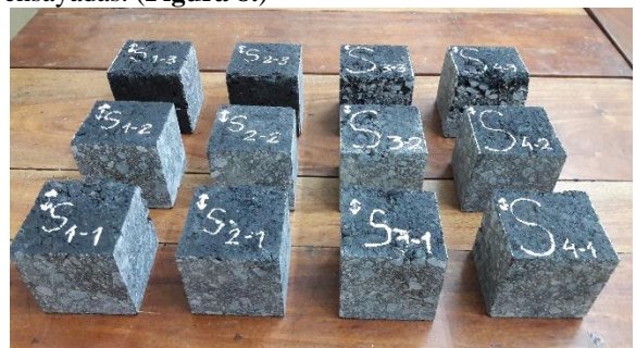
Figura 8. Probetas cúbicas generadas por aserrado.
