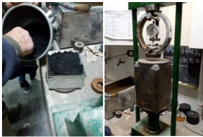
Imagen 5. Moldeo y compactación
