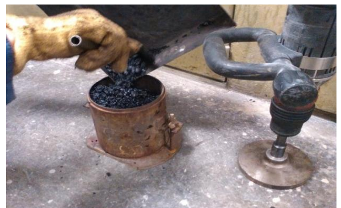
Figura 2. Colocación de la mezcla en el molde
