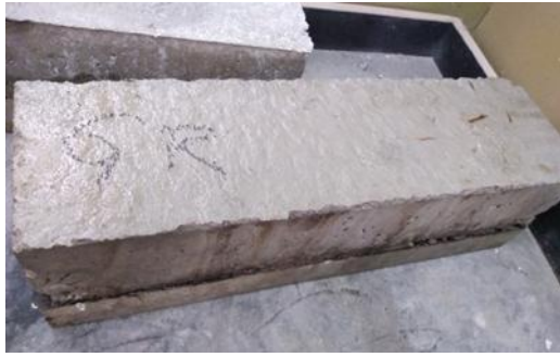
Figura 8 Viga con refuerzo de Geogrilla
