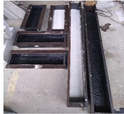
Figura4 Dosificación H° pobre y aplicación emulsión
