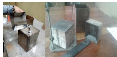
Imagen 4. Molde, pistón y cubre pistón
