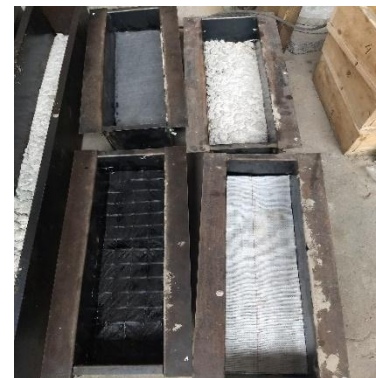
Figura5 Colocación materiales geosintéticos
