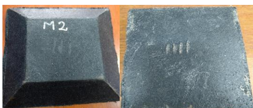
Imagen 7. Tacha moldeo 2 (14 % de resina)
