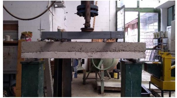
Figura 10 Viga sin refuerzo de fibras (BLANCO 4)
