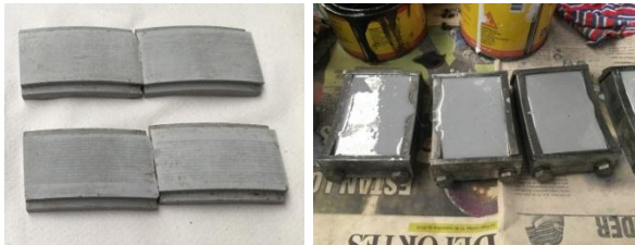
Figura 5. Confección de las probetas con sustrato MA.
