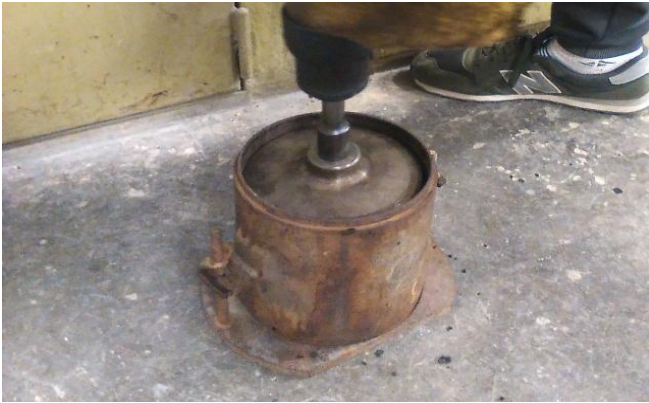
Figura 3. Compactación de la mezcla
