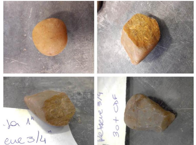
Figura 3. Partícula sin caras de fractura (arriba, izq.), partícula con 1 cara de fractura (arriba, der.), partícula con 2 caras de fractura (abajo, izq.) y partícula con 3 o más caras de fractura (abajo, der.)
