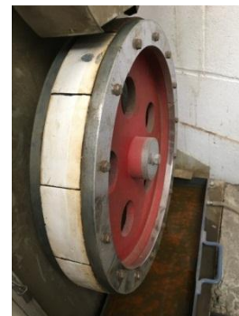
Figura 6. Probetas en equipo de pulimento acelerado.
