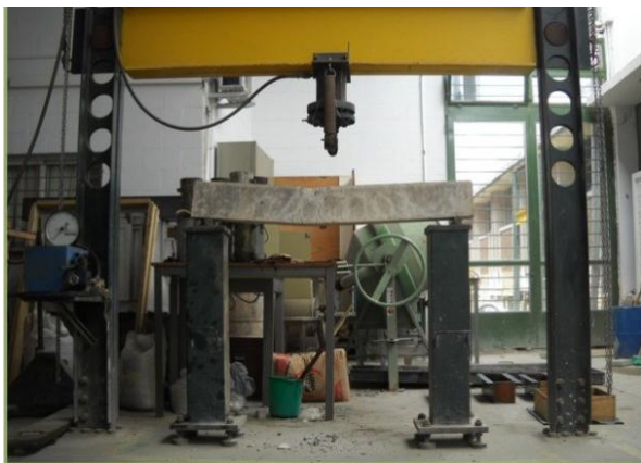
Figura 3 pórticos de carga
