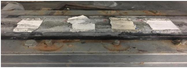
Figura 12. Muestras luego de 3000 pasadas.
