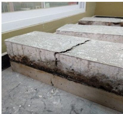
Figura 9 Viga con refuerzo de Geotextil (GTX) ensayada
