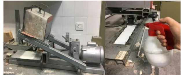
Figura 6. Izq.: Equipo LWT del LEMaC; Der.: rociado con agua de la muestra durante el ensayo.
