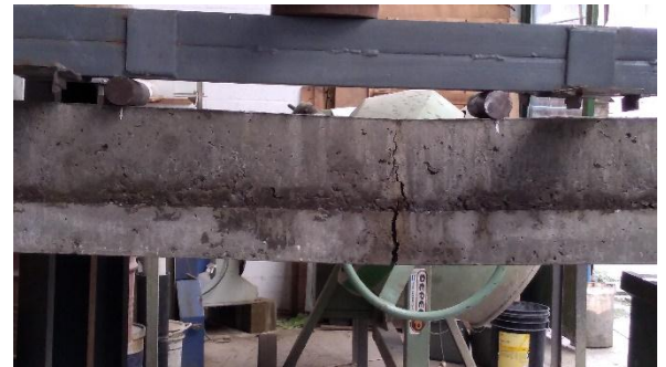
Figura 11 Viga con refuerzo de Geogrilla (GR 6) ensayada
