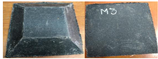
Imagen 8. Tacha moldeo 3 (10% de resina)
