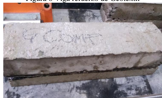
Figura 7 Viga con refuerzo de Geocompuesto
