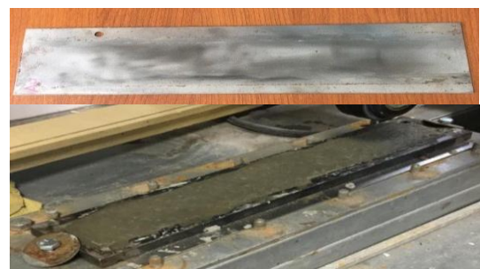
Figura 3. Arriba: Sustrato chapa; abajo: Sustrato Mortero
