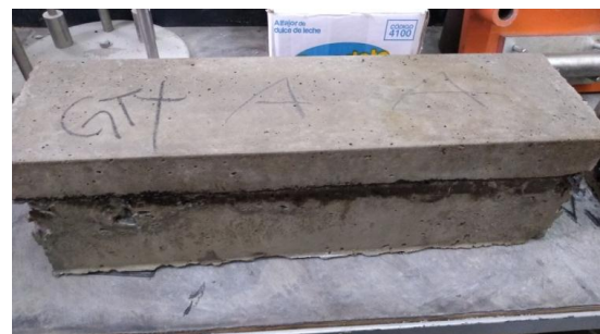
Figura 6 Viga refuerzo de Geotextil
