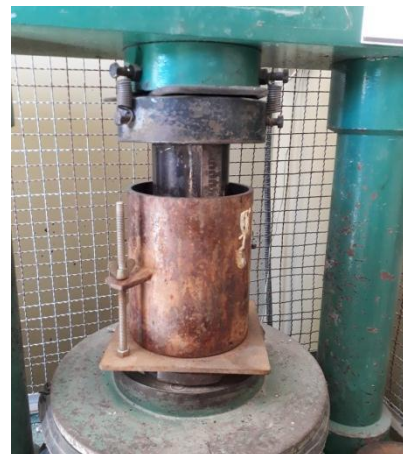
Figura 4. Moldeo de probeta de VSR a densidad prefijada. Se establece una Densidad de Referencia de 2,000 g/cm 3 y una Humedad de Moldeo del 1 %. Además se decide
