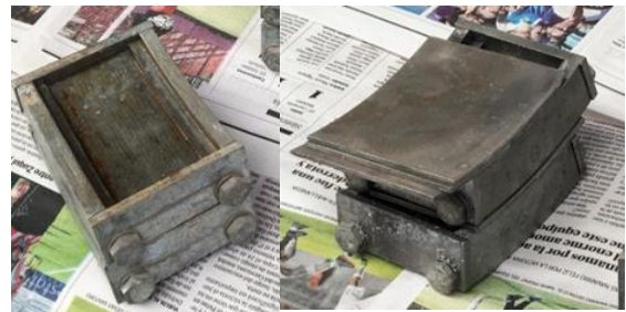
Figura 2. Moldes utilizados para el ensayo de Pulimento acelerado.
