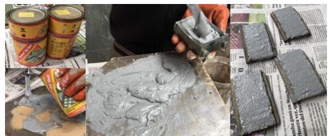
Figura 3. Confección de las probetas con sustrato A.
