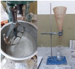
Figura 2. Cono de marsh y mezcladora hobart
