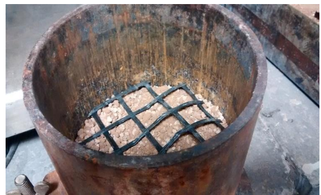
Figura 15- Colocación de geomalla
