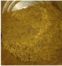
Imagen 13. Mezcla de NFU con hidróxido de hierro y resina bi componente
