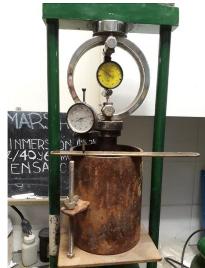
Figura 7. Realización de un ensayo de VSR
