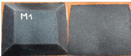
Imagen 6. Tacha Moldeo 1 (12% de resina)
