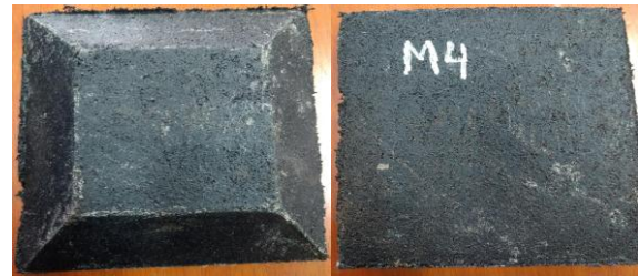
Imagen 9. Tacha moldeo 4 (8% de resina)
