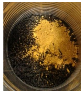
Imagen 12. Mezcla de M1 y polvo de NFU con ferrite.
