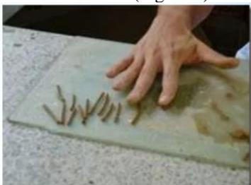
**Figura 2 - Amasado de cilindros para la determinación del Límite Plástico**
