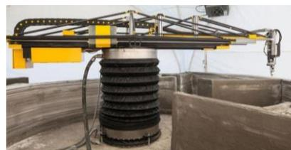
Figura 7. Apis Cor House (movimiento en el plano tipo radial, con brazo extensible que sostiene la boquilla y desplazamiento central en z).
