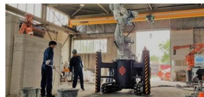
Figura 8. Impresora 3D de Ciber Control robótico de 6 ejes (movimiento rotacional de varios ejes para resolver la configuración x, y, z, y sus variables angulares).
