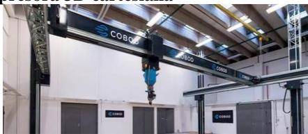
Figura 4. Impresora del tipo puente grúa, con rieles superiores (movimiento por rieles suspendidos en ejes x e y, y en eje z por columnas sobre 4 vértices).
