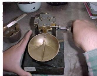
Figura 1 - Cascador de Casagrande
