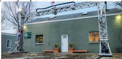
Figura 5. Impresora con rieles inferiores. Movimiento en eje x con riel suspendido y en eje y con 2 columnas móviles que se desplazan sobre rieles fijos, sobre el suelo.
