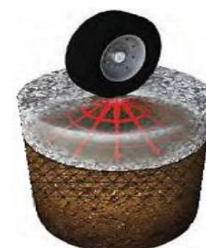
Figura 3. Efecto distribución de carga
