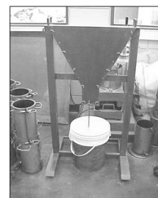
Figura 10: V-Funnel para hormigones.
