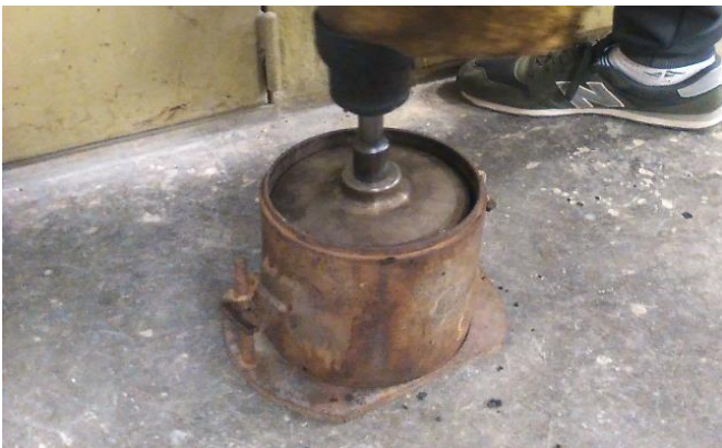
Figura 3. Compactación de la mezcla
