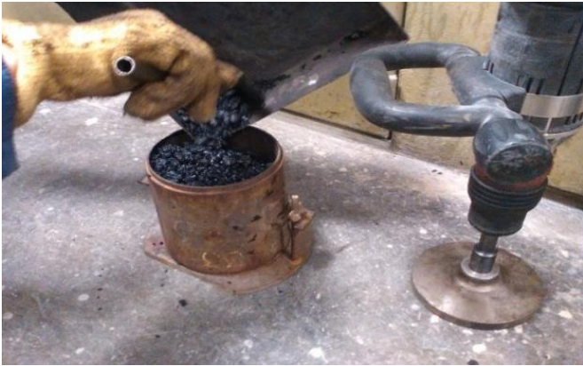
Figura 2. Colocación de la mezcla en el molde
