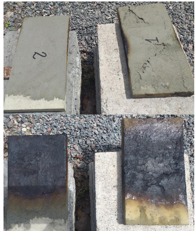
Figura 6: Resultado de la llama aplicada
