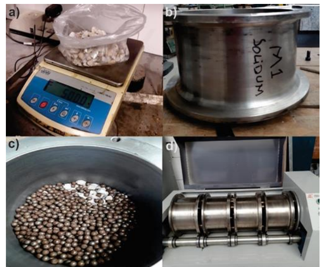
Figura 2. a) Pesaje del material. b) Cilindro hueco de acero. c) Bolillas de acero. d) Cilindros de acero en el soporte.
