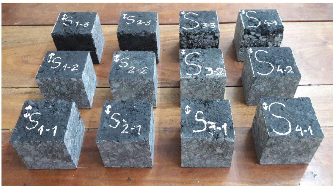
Probetas cúbicas aserradas
