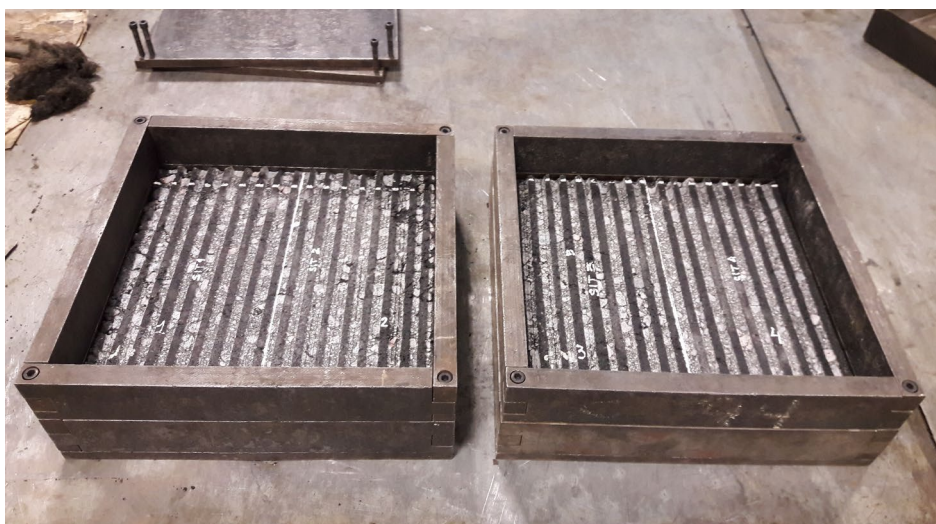
Bases para las probetas fresadas
