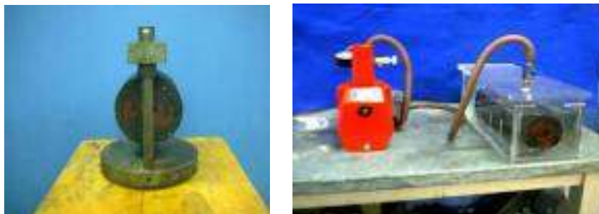
Equipo para el test de Lottman
