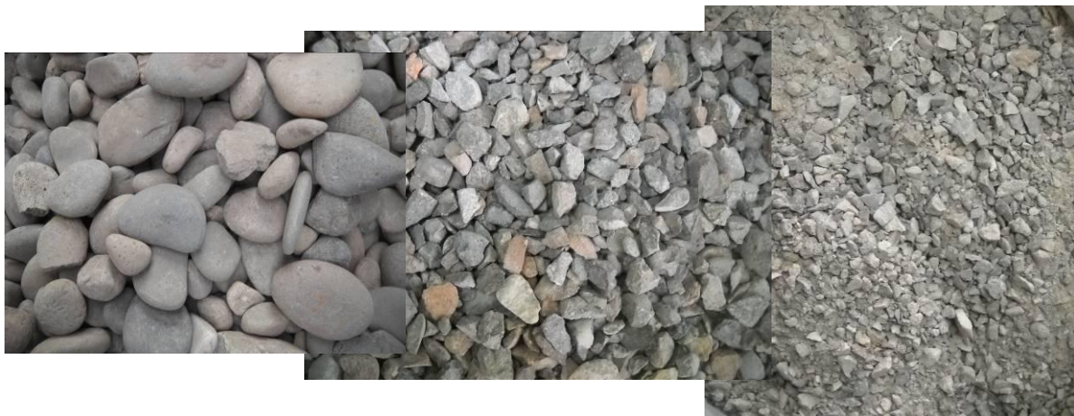
Foto N° 1: Paso de un canto rodado de 4 pulgadas a árido 6:20 y arena de trituración 0:6 con el sistema descrito
