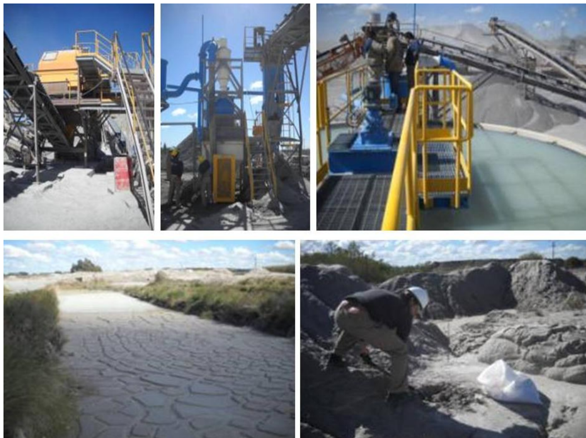
Foto 1 - Entrada de arena al tamizado, floculación de las fracciones que pasan el Tamiz Nº 200, secado de filler y de área de depósito
