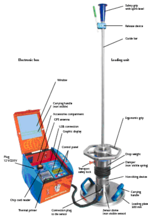
Figura 1. Light Weight Deflectometer (Fuente: TERRATEST)
