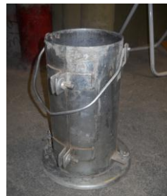
Figura N° 2: Molde metálico de una sola pieza
