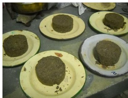
Figura N° 15: separación en las distintas capas donde se observa disgregamiento del material
