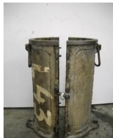
Figura N° 1: Molde metálico de dos piezas
