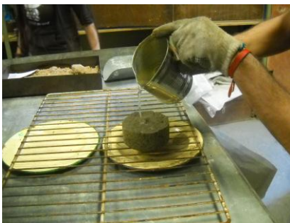
Figura N° 18: impermeabilización de la probeta a través de parafina fundida
