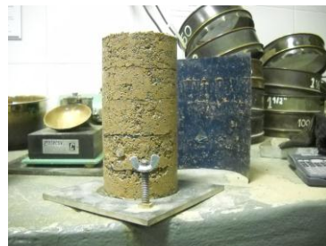
Figura N° 11: Probeta desmoldada evidenciando sus distintas capas
