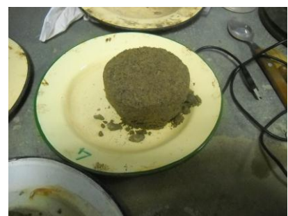
Figura N° 16: detalle del desprendimiento del material
