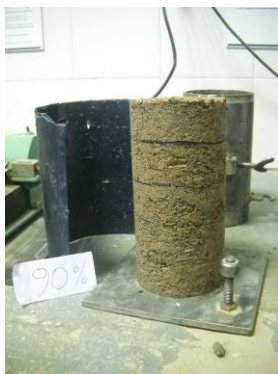
Figura N° 14: aspecto de la probeta compactada al 90%
