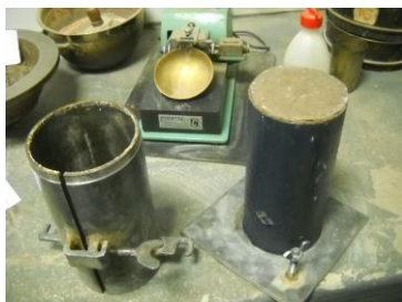
Figura N° 10: Probeta desmoldada con lámina de acetato aun adherida
