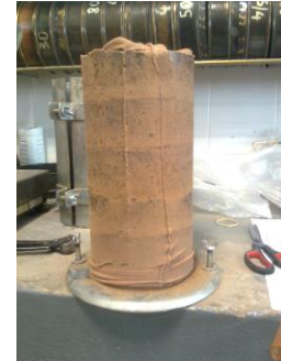
Foto N° 5: Probeta confeccionada y recubierta con material de lycra
