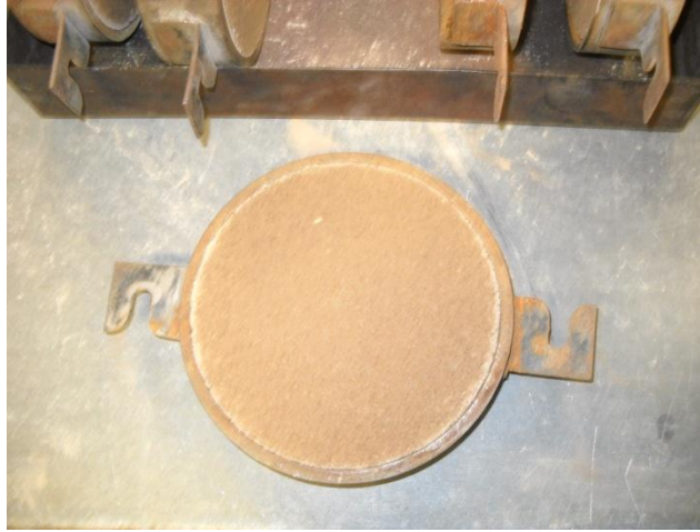
Figura 1. Molde metálico con la muestra del suelo
