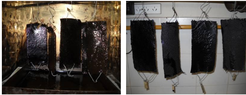
Figura 4 – Probetas colgadas, dentro y fuera de la estufa
