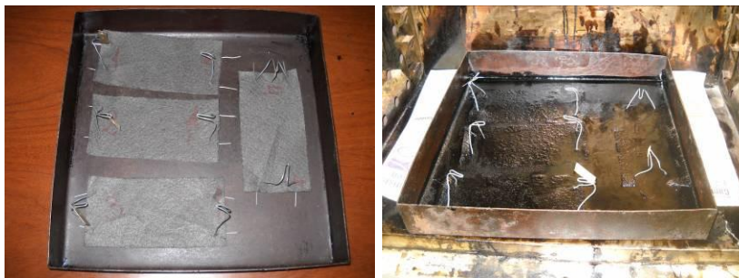
Figura 3 - Probetas antes y después de ser embebidas en emulsión
