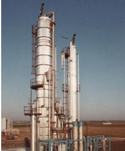
Foto 1 y 2: Destilación y traslado del asfalto a la planta asfáltica
