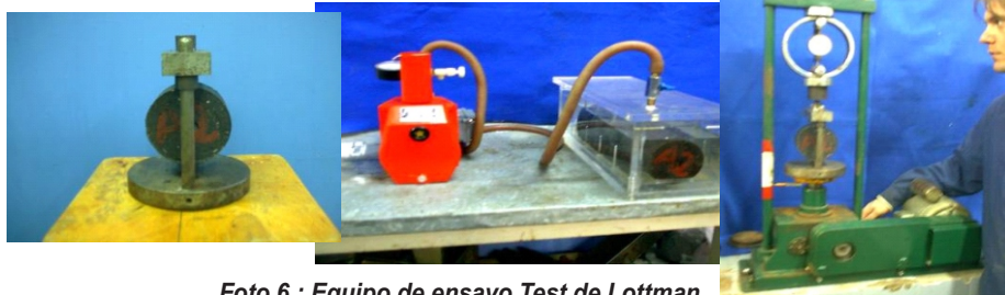
Foto 6 : Equipo de ensayo Test de Lottman
