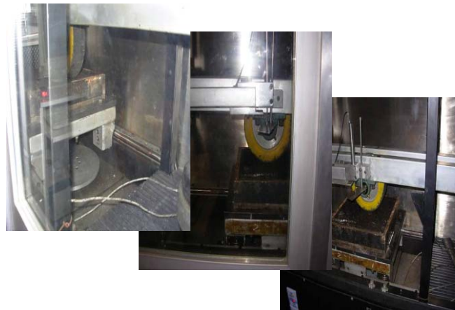
Foto 4 : Equipo de ensayo WTT
