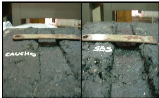
Foto 5 : Probetas ensayadas a ahuellamiento
