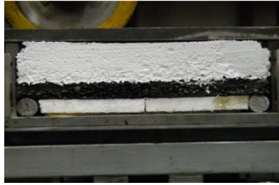
Figura 2: Probeta y sistema de apoyo propuesto
