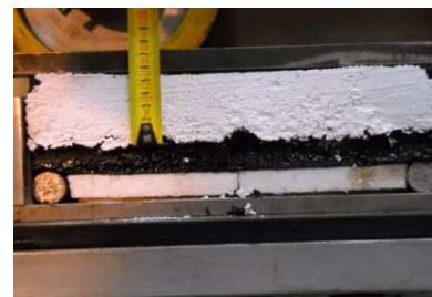
Figura 14: Fin ensayo minuto 90', h fisura = 50mm
