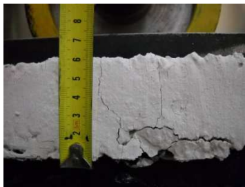
Figura 7: 4º parada minuto 40', h fisura = 50mm
