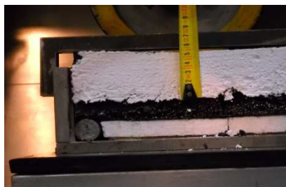
Figura 13: 8º parada minuto 60', h fisura = 34mm
