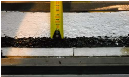
Figura 11: 2º parada minuto 10', h fisura = 24mm
