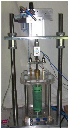
Figura 1. Equipo para determinación de Módulo Resiliente
