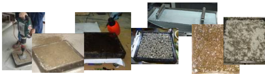
Figura 4: Secuencia de preparación de las muestras
