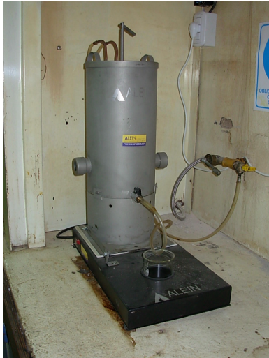
FOTO 2 y 3 - Método de recuperación de ligante Abson y - Centrifuga de vasos para la separación de finos del ligante asfáltico
