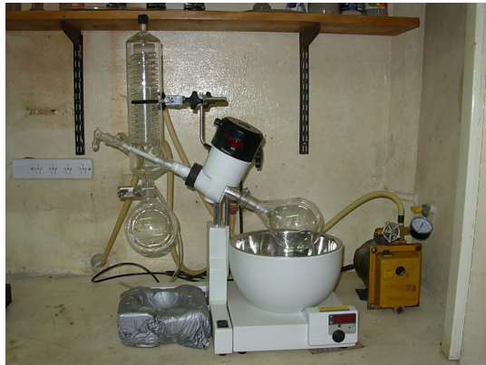
FOTO 4 Método de separación de solvente del ligante asfáltico por el Rotovapor.
