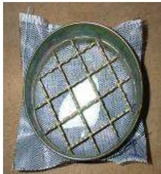
Geotextil preparado para ser ensayado
