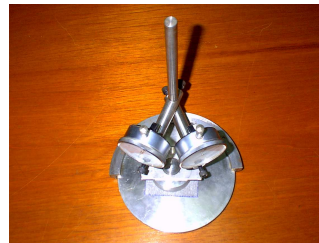
Placa de referencia, pie de presión con tetón, porta flexímetros, flexímetros y geotextil
