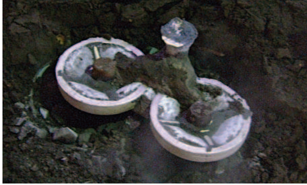
Molde de arena de fundición colapsado
