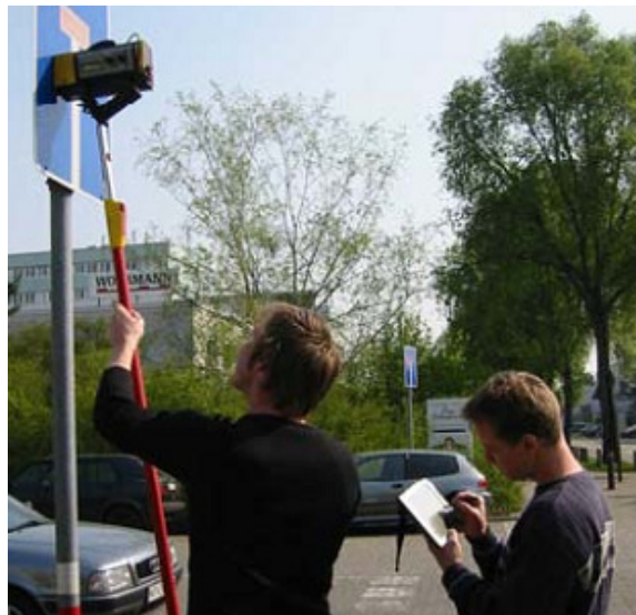
Foto Nº 3 medición de retroreflectancia en señales verticales
