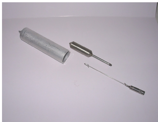
Foto N° 2: Cámara de muestra y juego porta aguja – alargador - aguja.
