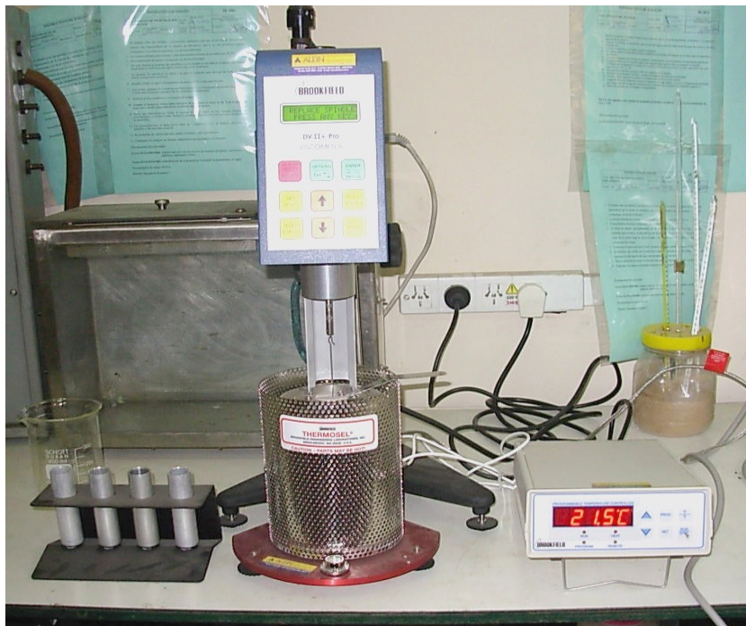
Foto N° 1: Viscosímetro Brookfield con cámara termostatazada de tipo Brookfield Thermosel.
