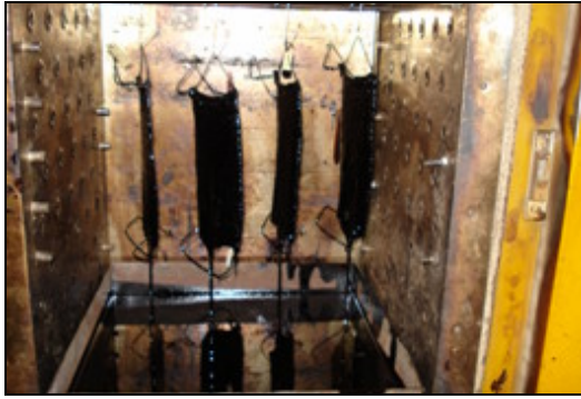
Figura 14 Geotextiles en etapa de escurrimiento
