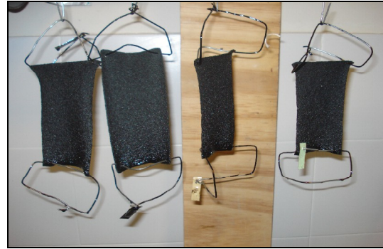
Figura 15 Geotextil en etapa de secado.
